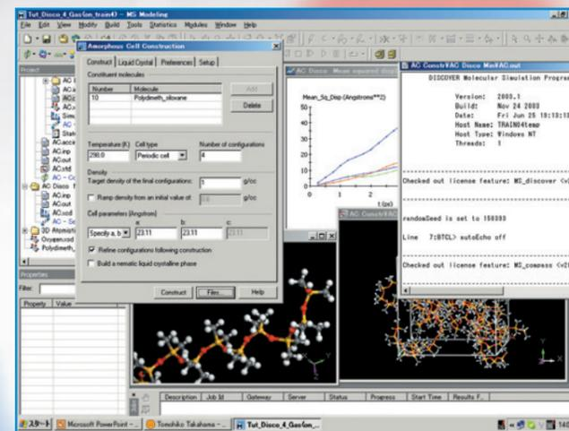
分子、結晶材料、ポリマーなどの三次元構造の作成から分子軌道図やダイナミクスの動的表示、表形式での解析などの高度な機能を持ち、すべてのMaterials Studioシミュレーションエンジン群への共通の入出力インターフェースプラットフォームとなります。
