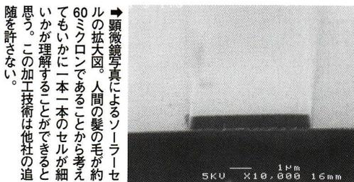
→顕微鏡写真によるソーラーセルの拡大図。人間の髪の毛が約60ミクロンであることから考えてもいかに一本一本のセルが細いかが理解することができると思ふ。この加工技術は他社の追随を許さない。
